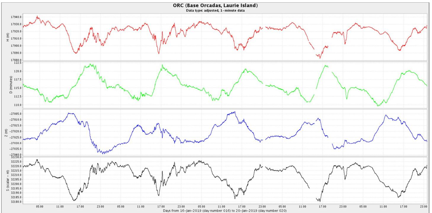
**Figura 4b:** Componentes del campo magnético del 11 al 20 de enero. En rojo se ve la componente horizontal ( $H$ ) y en azul la vertical ( $Z$ ), ambas en nT. En verde se presenta la declinación del campo magnético ( $D$ ) en minutos y en negro la intensidad del campo magnético en nT.
