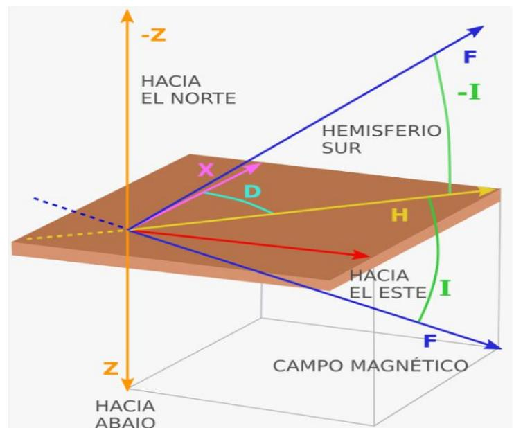
Figura 3: Componentes del campo magnético
