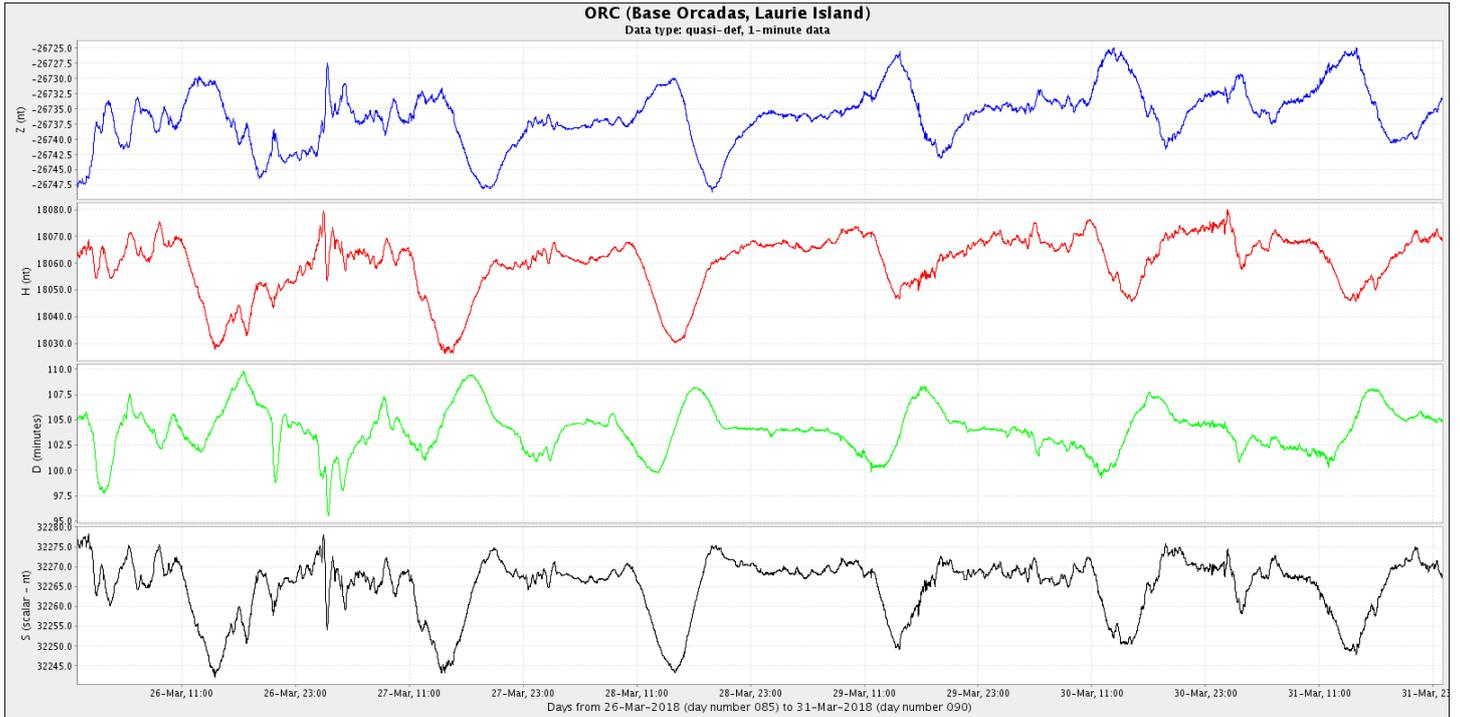
Figura 4c: Componentes del campo magnético del 26 al 31 de marzo. En rojo se ve la componente horizontal (H) y en azul la vertical (Z), ambas en nT. En verde se presenta la declinación del campo magnético (D) en minutos y en negro la intensidad del campo magnético en nT.
