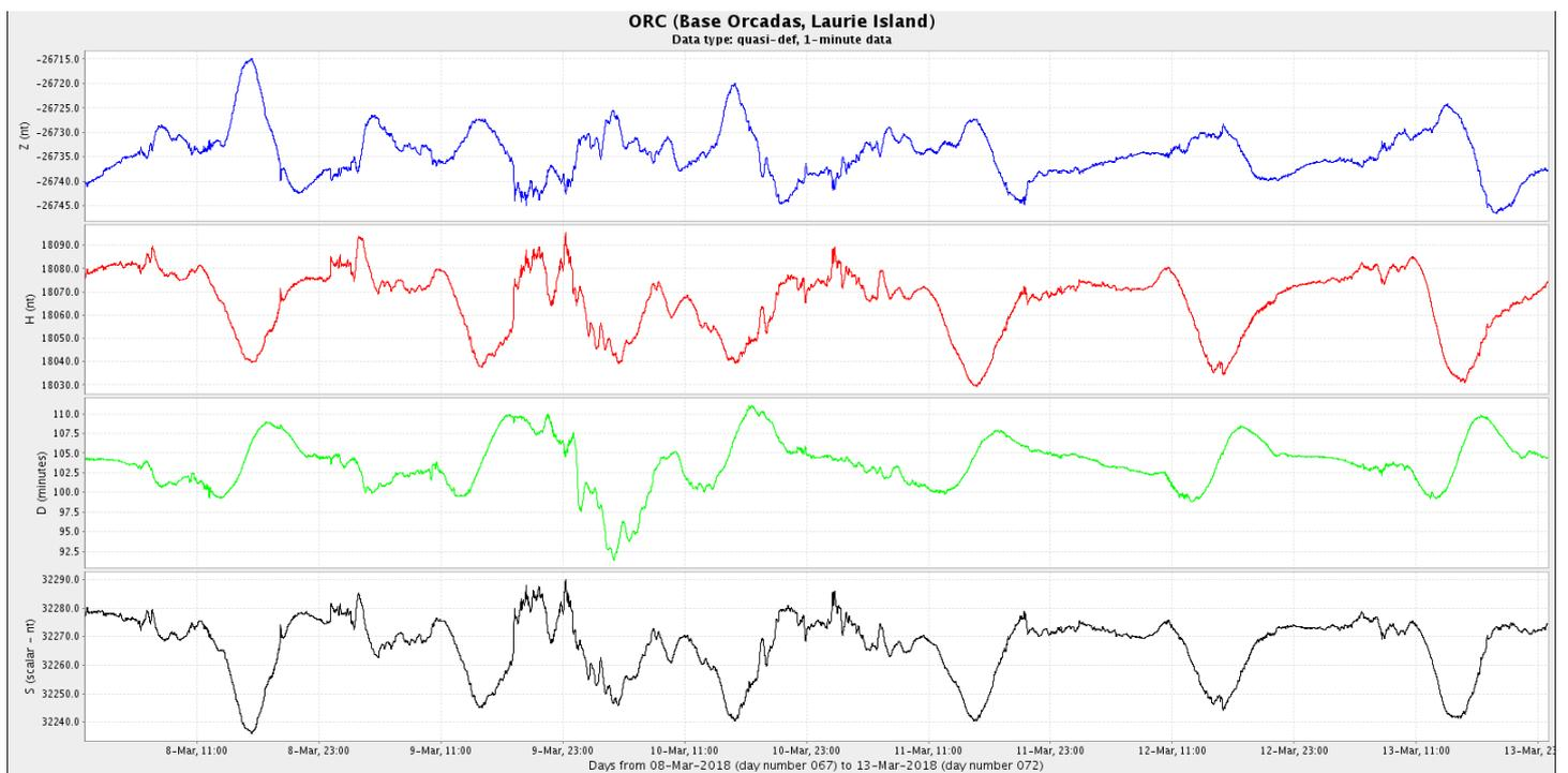
**Figura 4a:** Componentes del campo magnético del 1 al 13 de marzo. En rojo se ve la componente horizontal (H) y en azul la vertical (Z), ambas en nT. En verde se presenta la declinación del campo magnético (D) en minutos y en negro la intensidad del campo magnético en nT
