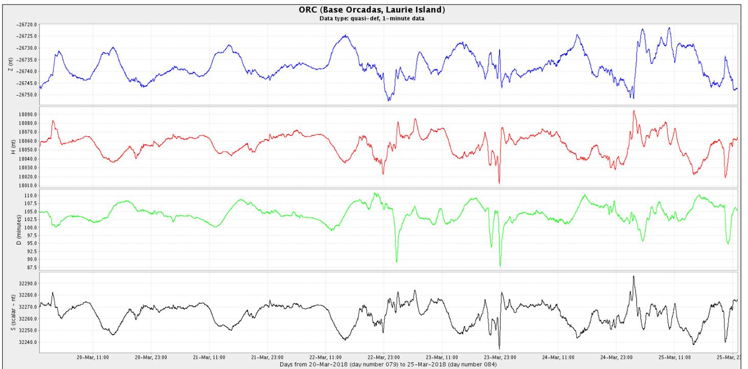
Figura 4b: Componentes del campo magnético del 14 al 25 de marzo. En rojo se ve la componente horizontal (H) y en azul la vertical (Z), ambas en nT. En verde se presenta la declinación del campo magnético (D) en minutos y en negro la intensidad del campo magnético en nT.
