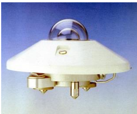
Figura 1. Piranómetros termoelectricos utilizados por el SMN
