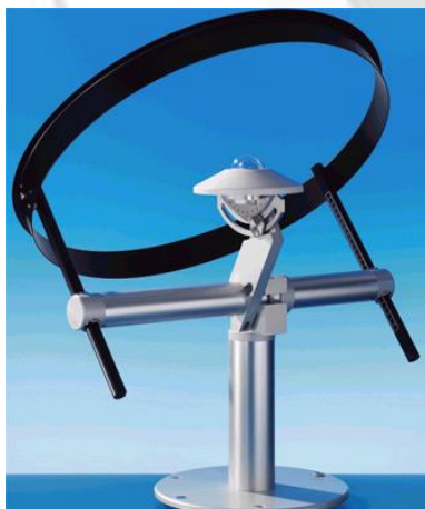
Figura 2. Piranómetros termoelectricos utilizados por el SMN
