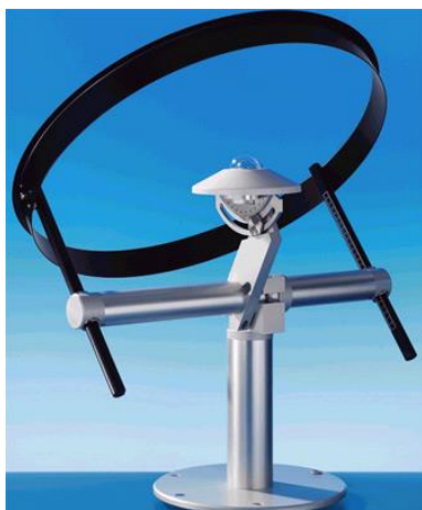
Figura 2. Piranómetros termoelectricos utilizados por el SMN
