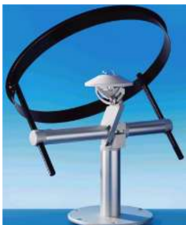
Figura 2. Piranómetros termoelectricos utilizados por el SMN
