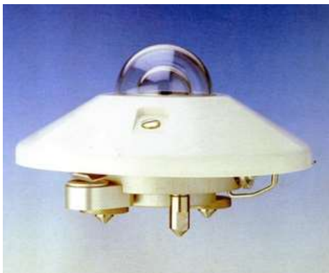
Figura 1. Piranómetros termoelectricos utilizados por el SMN
