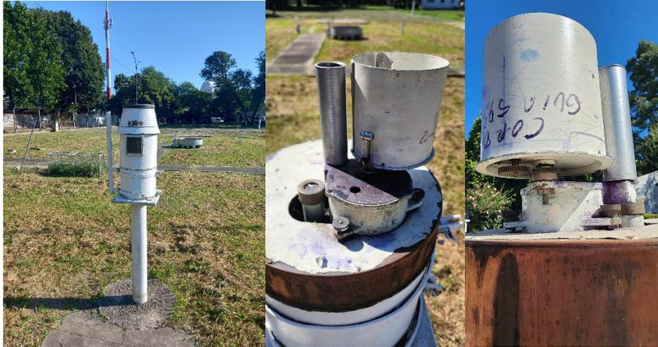
**Fig. 4.** Pluviógrafo de sifón en funcionamiento. A la izquierda, parte exterior del instrumento. Centro y derecha, componentes internas. (Foto enviada por personal de la estación Observatorio Central de Buenos Aires)
