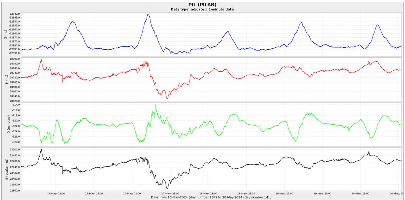
**Figura 4b:** Componentes del campo magnético del 10 al 20 de mayo. En rojo se ve la componente horizontal (H) y en azul la vertical (Z), ambas en nT. En verde se presenta la declinación del campo magnético (D) en minutos y en negro la intensidad del campo magnético en nT.
