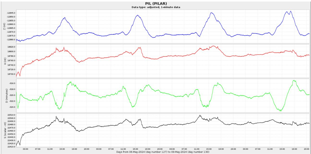
**Figura 4a:** Componentes del campo magnético del día 1 al 09 de mayo. En rojo se ve la componente horizontal (H) y en azul la vertical (Z), ambas en nT. En verde se presenta la declinación del campo magnético (D) en minutos y en negro la intensidad del campo magnético en nT.
