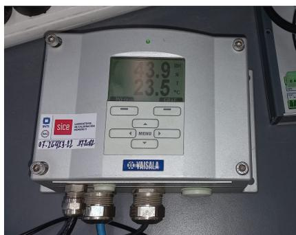
**Figura 5:** Sensor patrón de referencia de temperatura y humedad.
