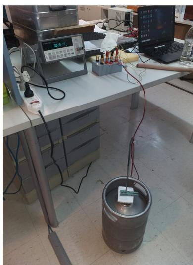
(a) PT100 conectado al multímetro.
