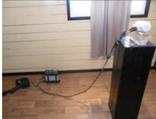
Fig. 7: Teodolito y PPM de campaña sobre pilar de observación
