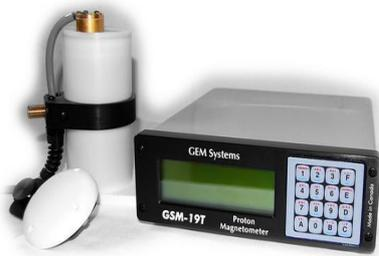
Magnetómetro de Precesión Protónica y su electrónica
