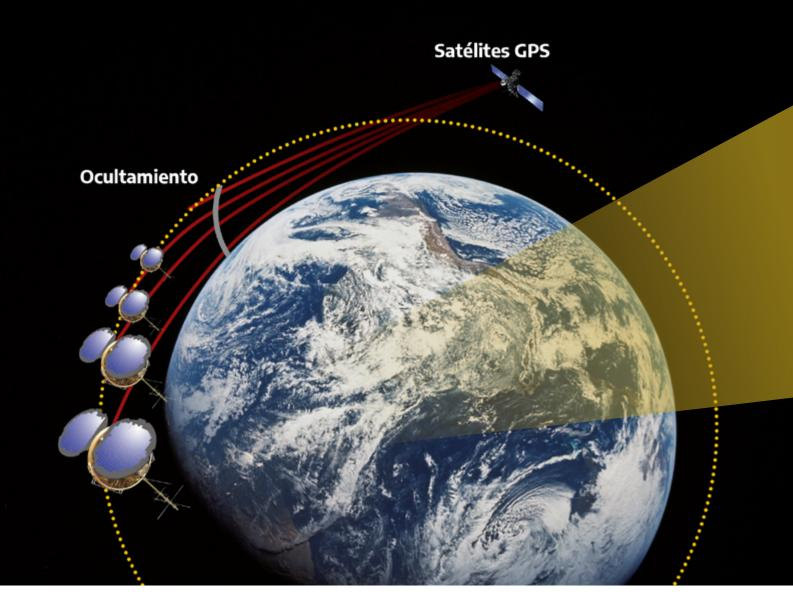
en la determinación de posiciones. Este error, de acuerdo a su propósito original, es aprovechado para obtener información de propiedades de la atmósfera. La exactitud del sistema se basa en el hecho de que la señal está precisamente controlada por relojes atómicos.
