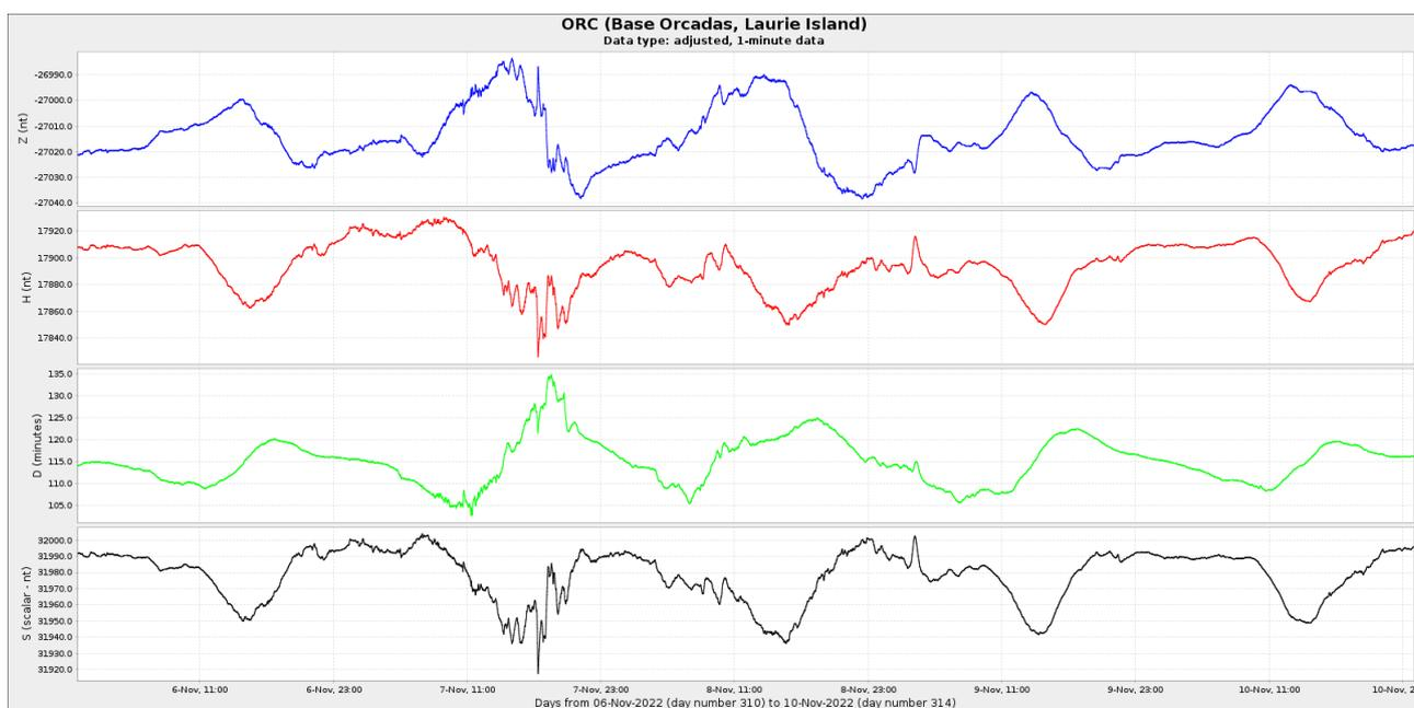
**Figura 4a:** Componentes del campo magnético del 1 al 10 de noviembre. En rojo se ve la componente horizontal (H) y en azul la vertical (Z), ambas en nT. En verde se presenta la declinación del campo magnético (D) en minutos y en negro la intensidad del campo magnético en nT
