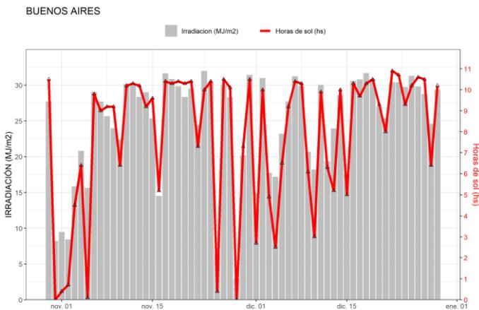
Figura 17. Irradiación solar global diaria y horas de sol obtenidas en Buenos Aires.
