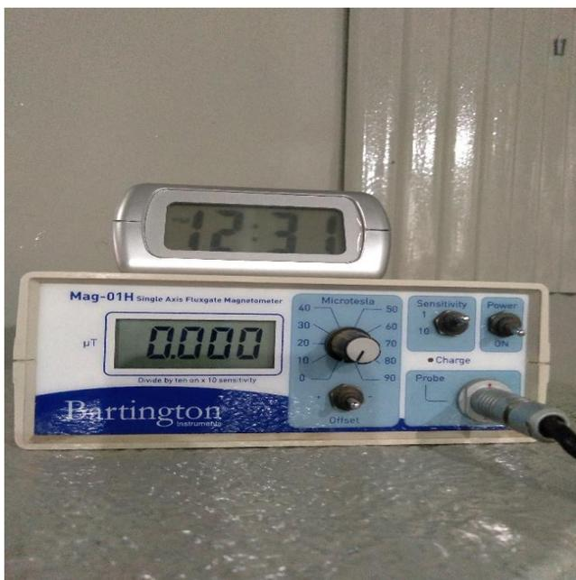
Imágenes: Juan Carlos Gil/ Magnetómetro fluxgate Bartington utilizado para la determinación de inclinación y declinación magnética.
