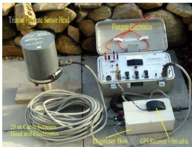
alambre. Cuando el magnetómetro está activo, la corriente alterna pasa a través de una de las bobinas, conocida como la “bobina”, creando campos magnéticos inducidos de diferentes intensidades. Los cambios en los campos magnéticos generan una corriente eléctrica en la segunda bobina, conocida como la “bobina de detección”, que a continuación se puede medir.
