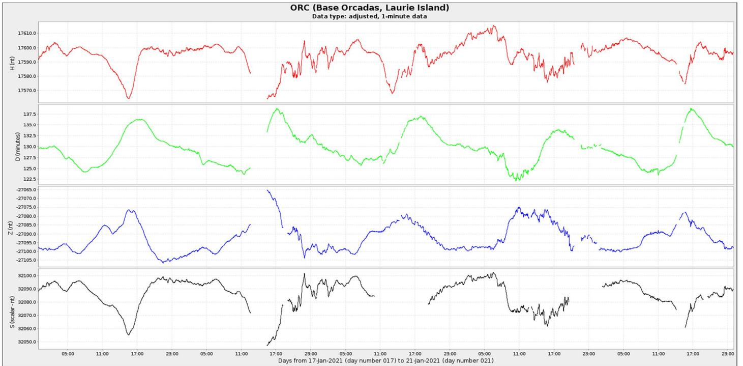
**Figura 4b** Componentes del campo magnético del 11 al 21 de enero. En rojo se ve la componente horizontal ( $H$ ) y en azul la vertical ( $Z$ ), ambas en nT. En verde se presenta la declinación del campo magnético ( $D$ ) en minutos y en negro la intensidad del campo magnético en nT.
