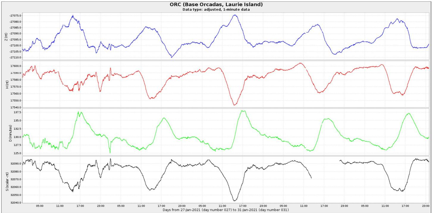
**Figura 4c:** Componentes del campo magnético del 22 al 31 de enero. En rojo se ve la componente horizontal (H) y en azul la vertical (Z), ambas en nT. En verde se presenta la declinación del campo magnético (D) en minutos y en negro la intensidad del campo magnético en nT.
