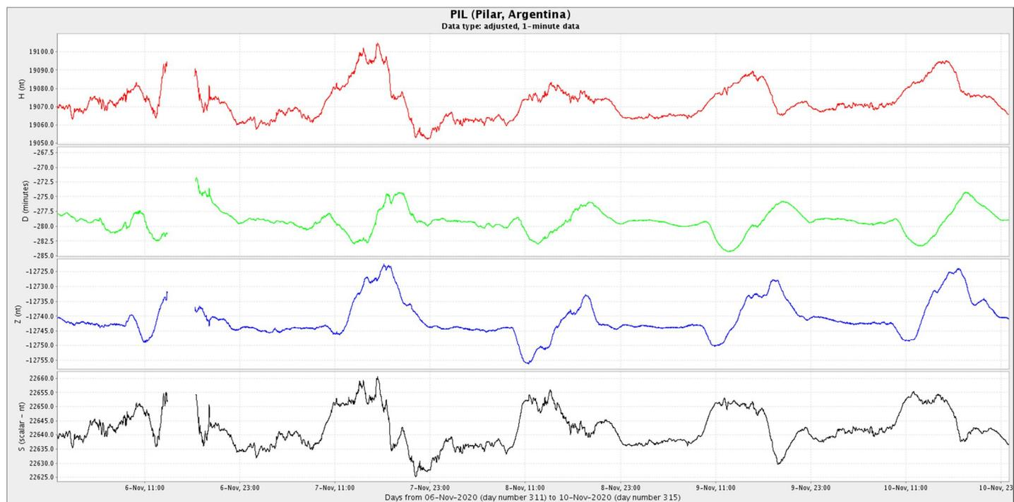
Figura 4a: Componentes del campo magnético del día 1al 10 de noviembre. En rojo se ve la componente horizontal (H) y en azul la vertical (Z), ambas en nT. En verde se presenta la declinación del campo magnético (D) en minutos y en negro la intensidad del campo magnético en nT
