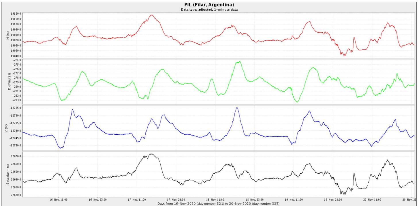
**Figura 4b:** Componentes del campo magnético del 11 al 20 de noviembre. En rojo se ve la componente horizontal ( $H$ ) y en azul la vertical ( $Z$ ), ambas en nT. En verde se presenta la declinación del campo magnético ( $D$ ) en minutos y en negro la intensidad del campo magnético en nT.
