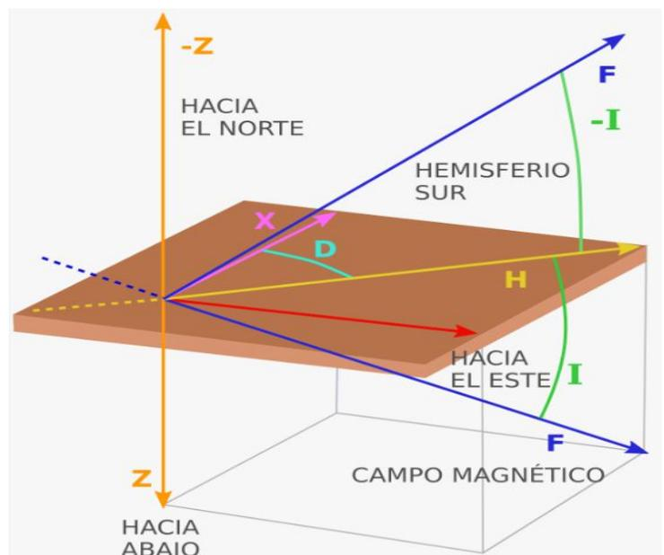
Figura 3: Componentes del campo magnético
