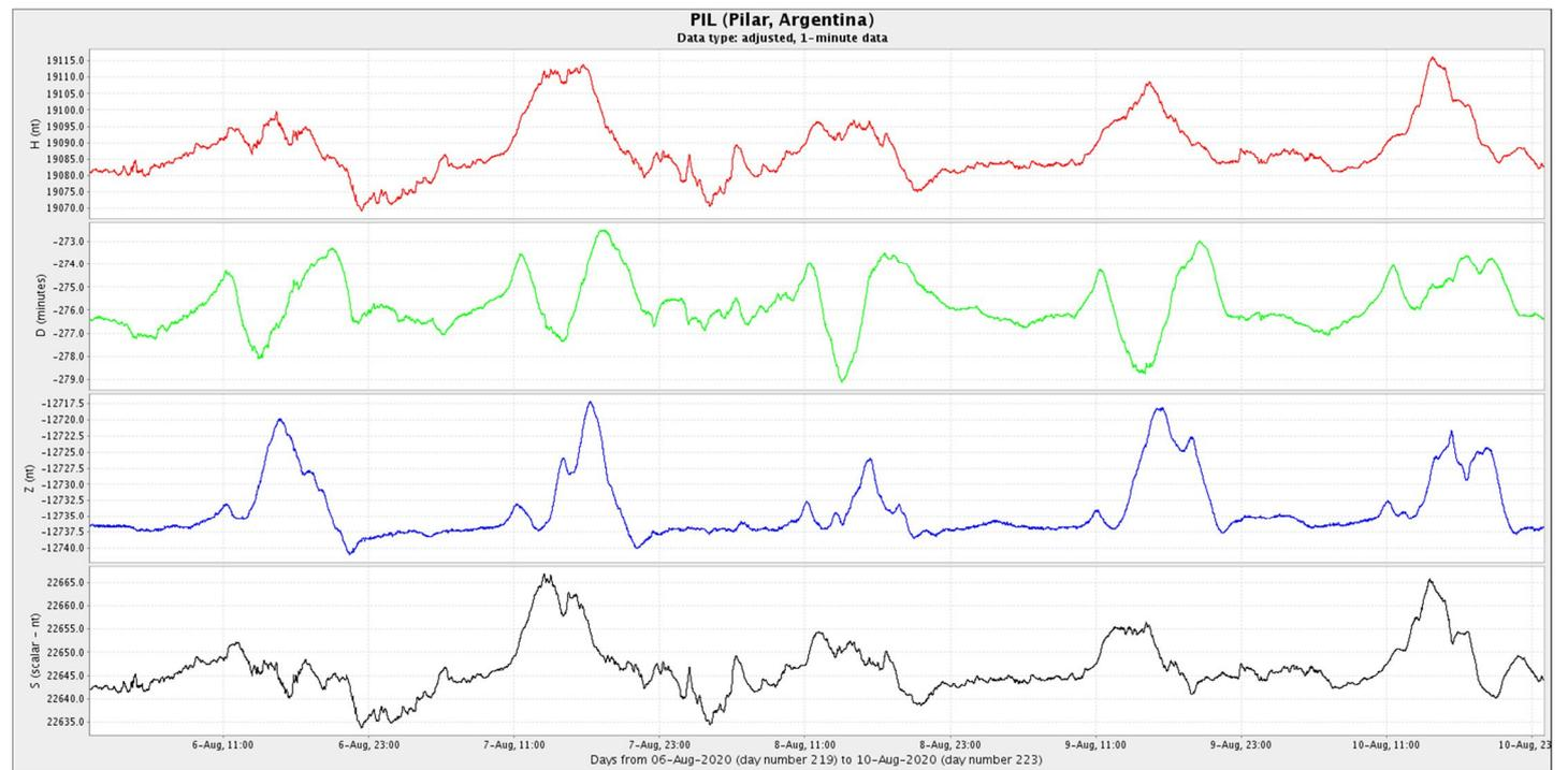
Figura 4a: Componentes del campo magnético del día 1al 10 de agosto. En rojo se ve la componente horizontal (H) y en azul la vertical (Z), ambas en nT. En verde se presenta la declinación del campo magnético (D) en minutos y en negro la intensidad del campo magnético en nT
