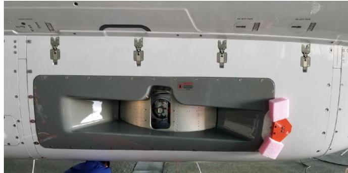
**Fig. 4:** Vista del detalle del espectrofotómetro infrarrojo del instrumento GLORIA.
