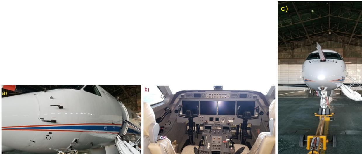
**Fig. 5:** Componentes del sistema BAHAMAS. a) Sistema de turbos de pitot y termómetros. b) Cockpit de la aeronave con los sistemas de avionicas para mediciones de parámetros meteorológicos base. c) Detalle del ‘nose boom’ con los sistemas de medición de turbulencia.
