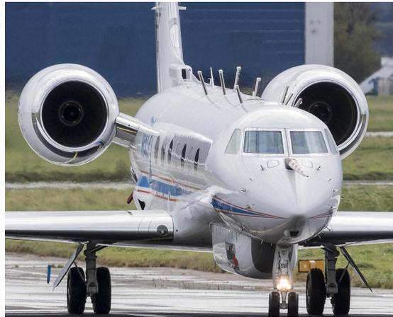
**Fig. 2:** Vista de frente de la aeronave HALO. Pueden verse las sondas y tubos de pitot utilizados en la parte superior del fuselaje y la 'panza' con instrumentos en la parte inferior. (Fuente: página web campaña SouthTRAC)
