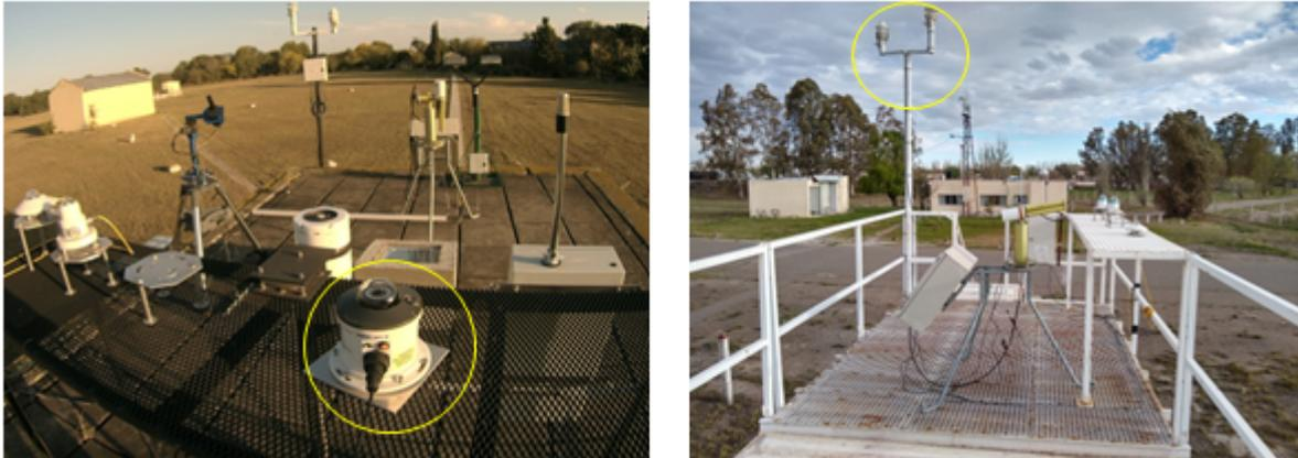
**Figura 10:** De izquierda a derecha. Cámara de cielo SONA 201D (Pilar) y Sensores WS200 y WS 400 (Neuquén)
