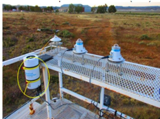
**Figura 9:** De izquierda a derecha. Sensores de radiación solar UVA, UVB y Piranómetro (Pilar) y Radiómetro multifiltro GUV 2511 (Comodoro Rivadavia)
