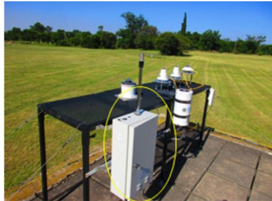
**Figura 8:** De izquierda a derecha. Fotómetro solar PANDORA (Neuquén) y Medidor de partículas TOPAS (Pilar).
