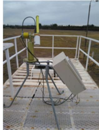
**Figura 7:** De izquierda a derecha. Lidar multilongitud de onda (Neuquén) y fotómetro solar CIMEL CE318 (Neuquén).
