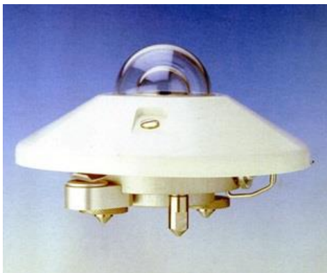
Figura 1. Piranómetros termoelectricos utilizados por el SMN
