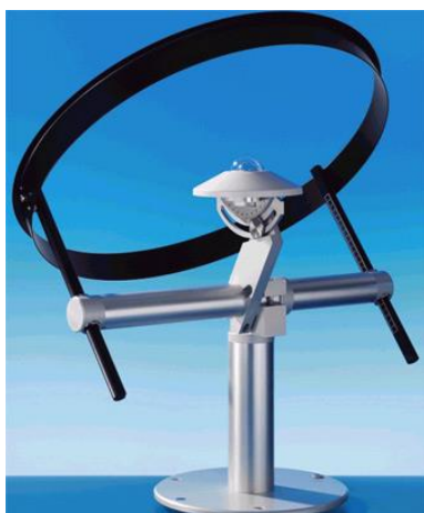
Figura 2. Piranómetros termoelectricos utilizados por el SMN
